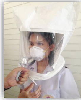
รูปที่ 9.15 การทดสอบความแนบสนิทการใส่หน้ากากชนิดใช้แล้วทิ้ง ด้วย fit test kit
