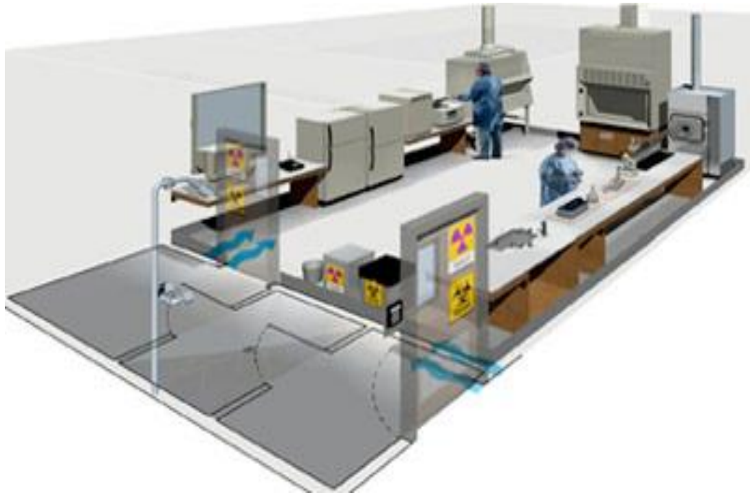
รูปที่ 4.4 ห้องปฏิบัติการชีววิทยาระดับ 3
