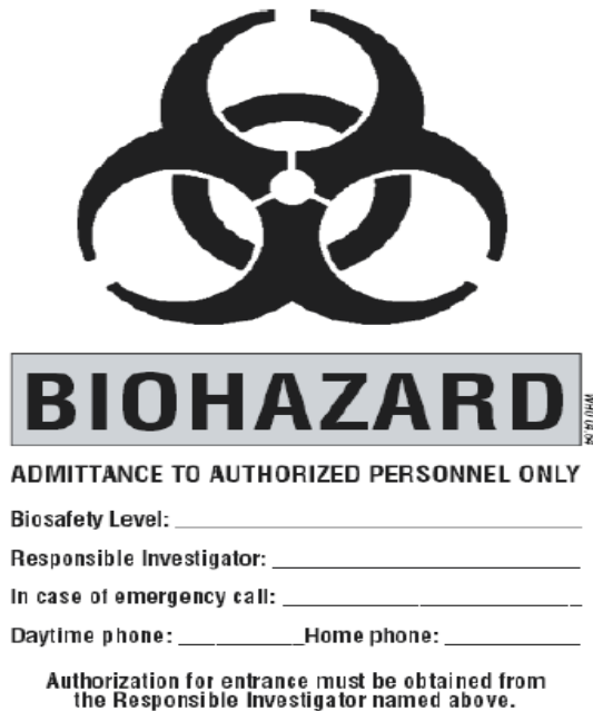
รูปที่ 4.3 ตัวอย่างป้ายสัญลักษณ์ชีวภัยสากลสำหรับติดหน้าประตูห้องปฏิบัติการ
